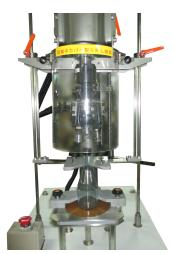
高さ調整は三か所 クランプノブを緩めるだけ で調整可能 Vガイド高さはヘッド追従式
