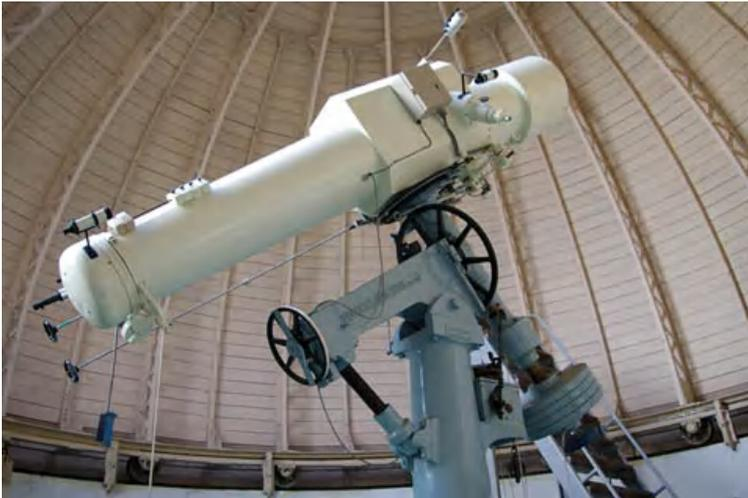
現在の鏡筒は30cm屈折用のドームで45cm対物レンズを使用するため2枚の平面鏡を使いハーシェル・ニュートン式反射のような構造の鏡筒になっている。鏡筒の東西に接眼部があり、鏡で切り替えができる。
