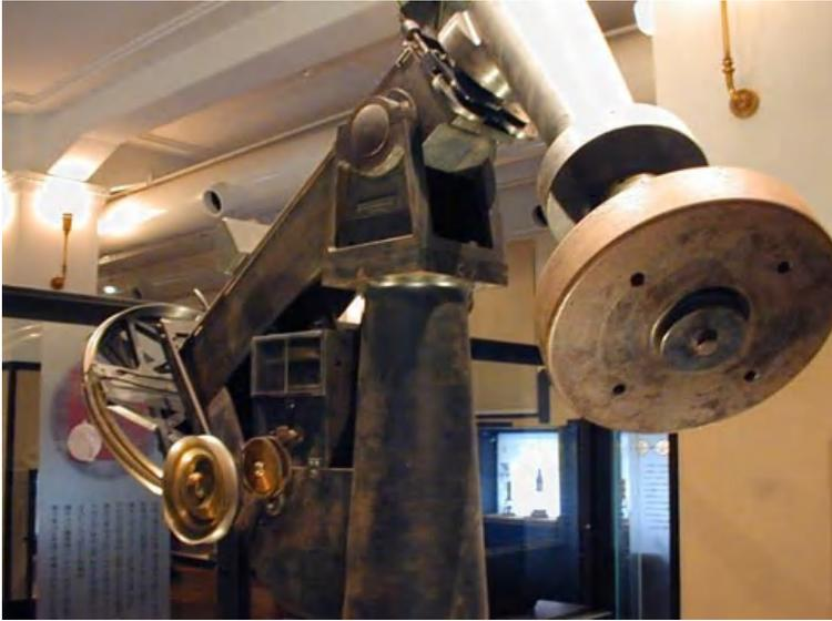
望遠鏡鏡筒、架台、錘、支柱は鉄製。鏡筒接眼部、歯車は真鍮製。この望遠鏡は長い極軸、極軸軸受けの構造、大きな極軸ウオーム・ギアが目を引く。鏡筒は先端より中央を太くして強度を保っている。錘垂式運転時計が付属。
