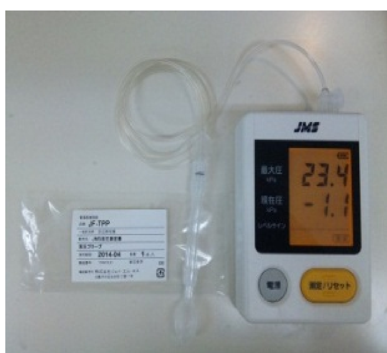
図1 JMS舌圧測定器
